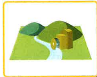
小水力発電 (単機出力1～1000kW以下)
