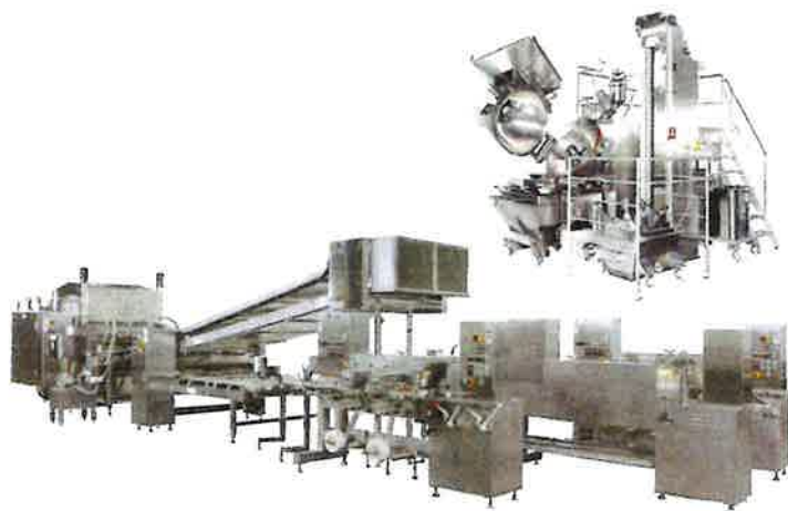
スーパーカニカマ製造装置(下)と、原料を高速処理するボールカッター
